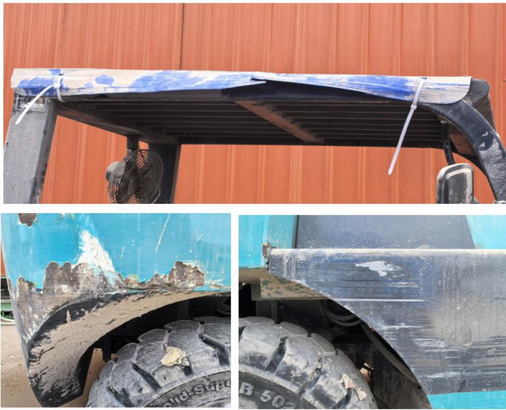
图9 涉事场（厂）内车辆顶棚右侧局部破损，车身右侧壳体多处擦伤
