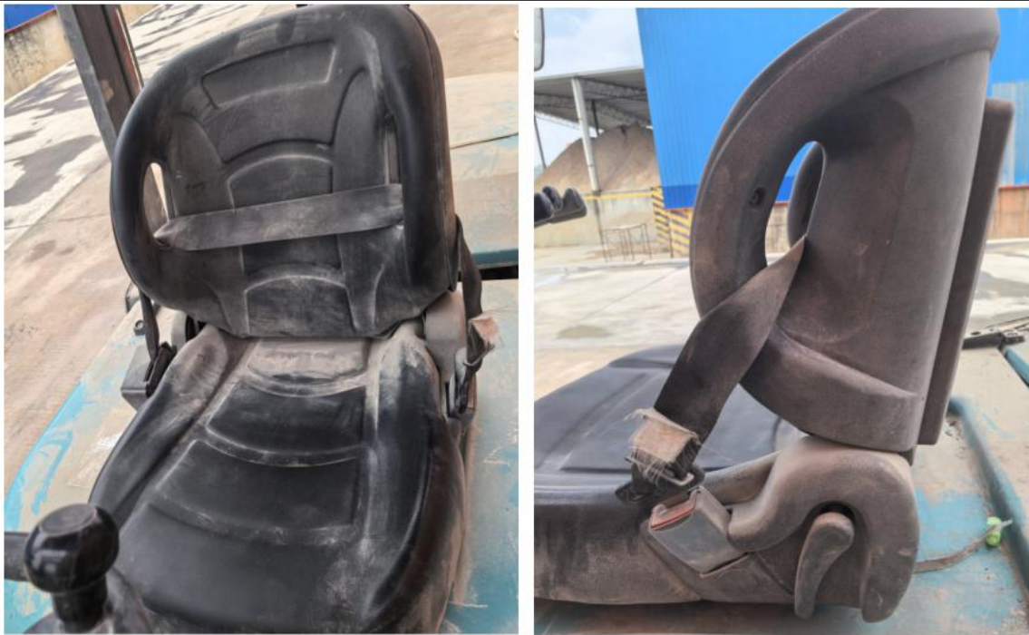
图10 安全带表层有积灰，未发现新鲜拉扯、佩戴使用的痕迹。
