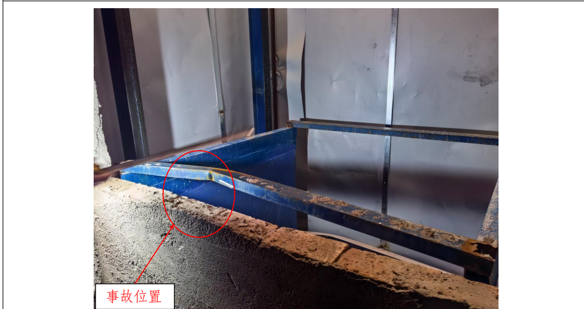
图 4 事发位置载货平台顶部横梁与死者发生挤压弯曲变形
