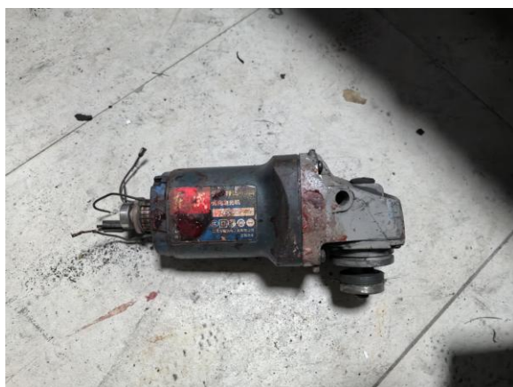
图 4 涉事角磨机外壳损坏，表面有血迹
