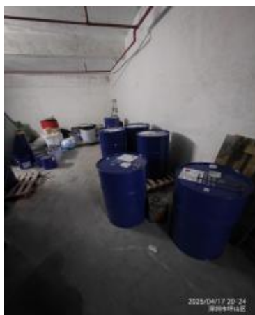
图 13 事发当天麦捷公司负二层房间内左、右两侧存放 19 个醋酸正丙酯包装桶，其中 4 个为敞口桶。
