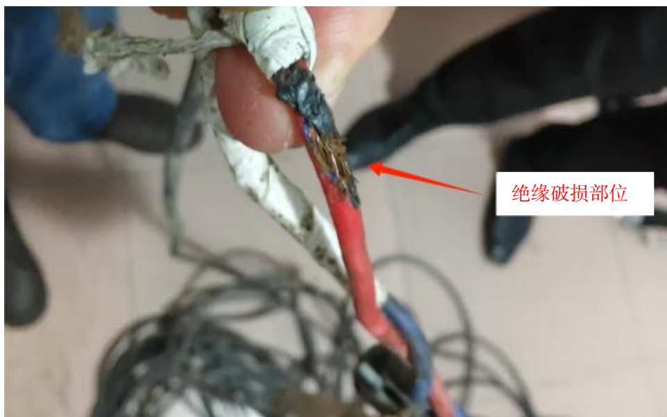
图 6 红色线有绝缘破损，金属导体裸露
