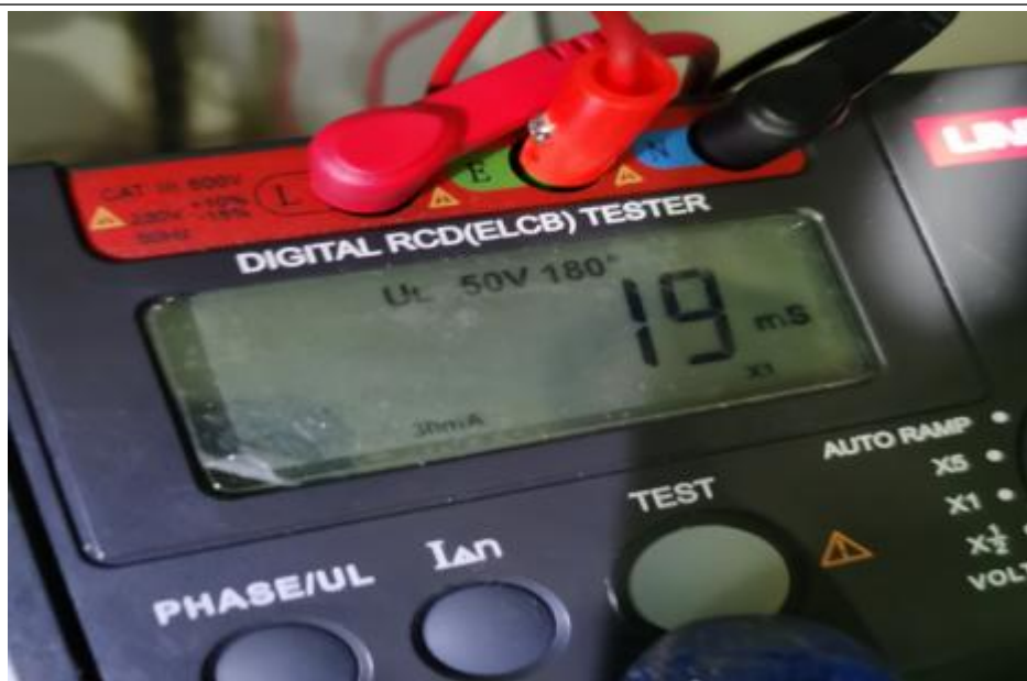
图 7 漏电保护器动作电流不大于 30 毫安，响应时间为 19 毫秒。
