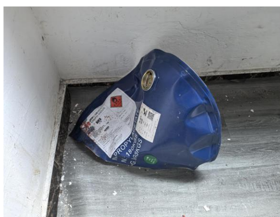
图 5 醋酸正丙酯包装桶顶盖飞出部分
