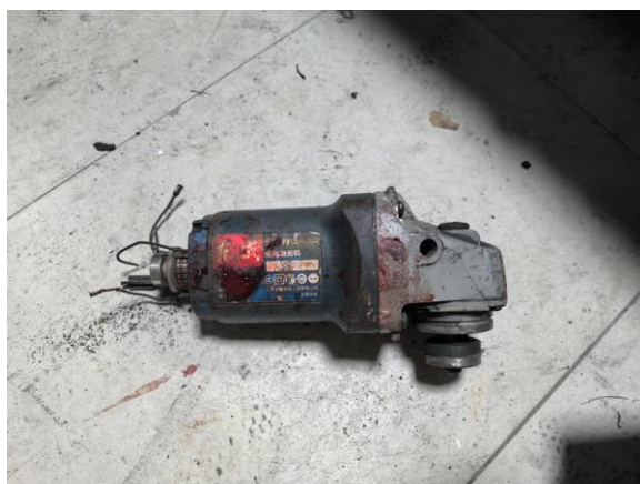
图 4 涉事角磨机外壳损坏，表面有血迹
