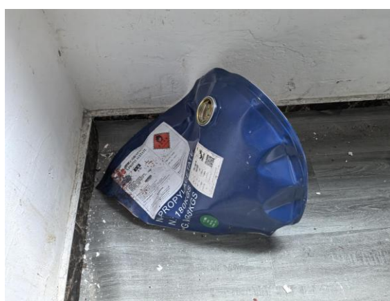
图 5 醋酸正丙酯包装桶顶盖飞出部分
