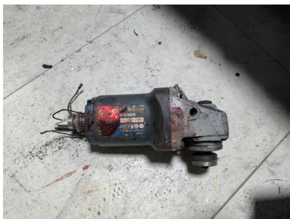
图 4 涉事角磨机外壳损坏，表面有血迹
