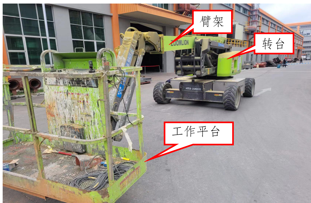
图 2 震雄工业园 B 区事故车辆情况
